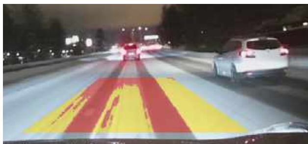
Bild 3: Med Ahead kan föraren få realtidsinformation om framförvarande vägs yta. De olika färgfälten visar olika typer av underlag.
